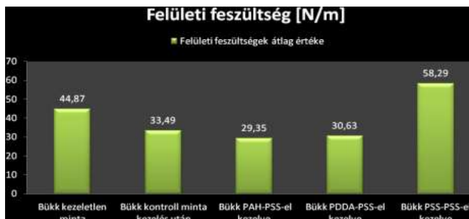
2. ábra - A mért felületi feszültség értékek nano kezelés után
